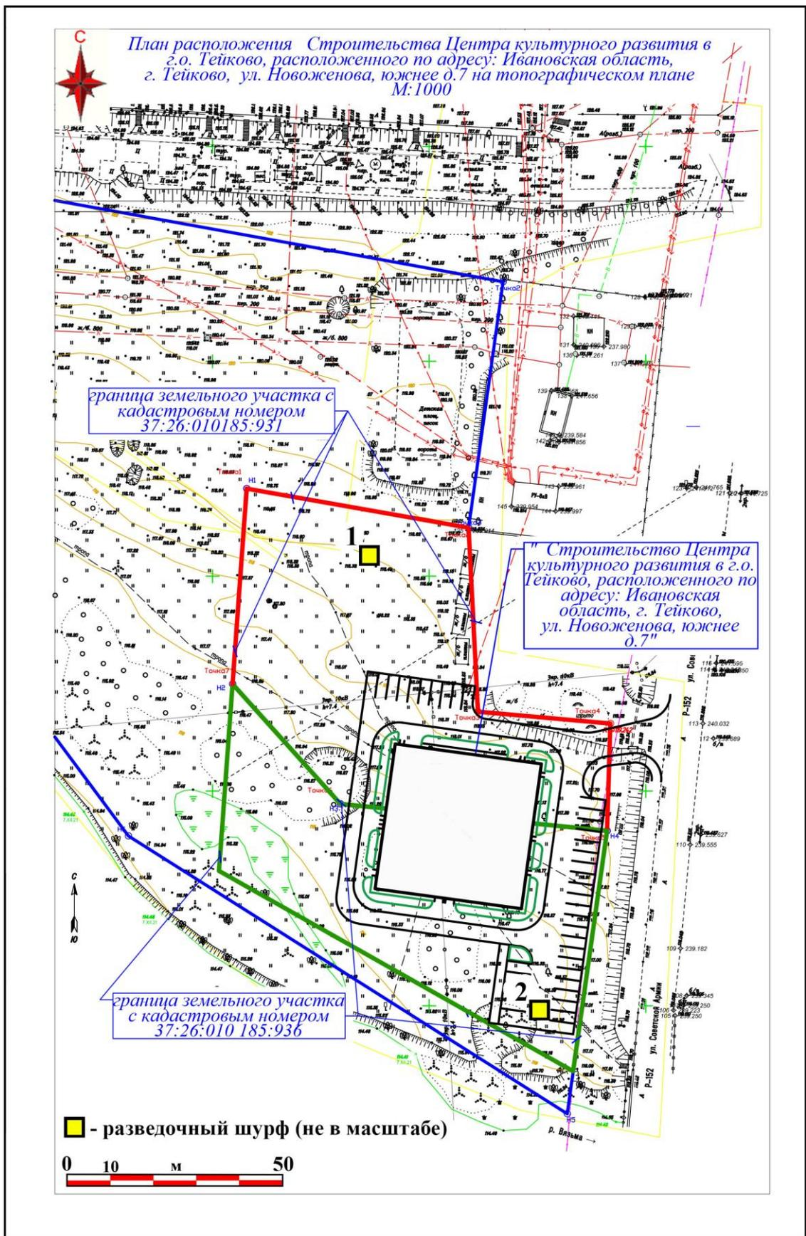
Рис. 7. Ивановская обл., г. Тейково, ул. Новоженова, участки с к/н 37:26:010185:931 и 37:26:010185:936. Топографический план участков работ (документация заказчика) с указанием проектируемого объекта и заложенных шурфов.
