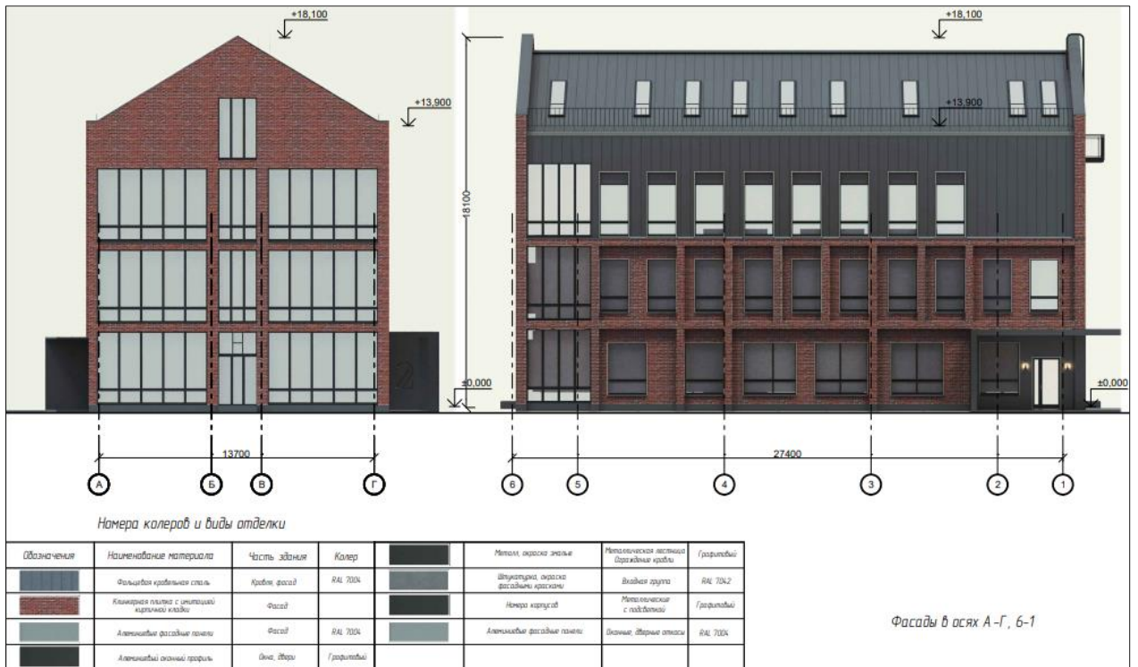
Рис. 8: Основные размеры и виды отделки Корпуса 2
