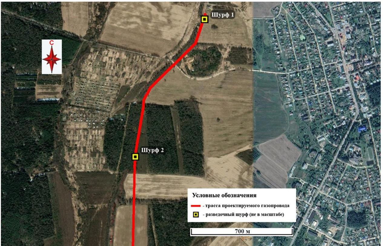
Рис. 27. Ивановская область, Палехский район, «газопровод д. Свергино – д. Хрулево». Космоснимок участка работ и шурфовки (Л. 1). YandexMaps [12.04.2021].
