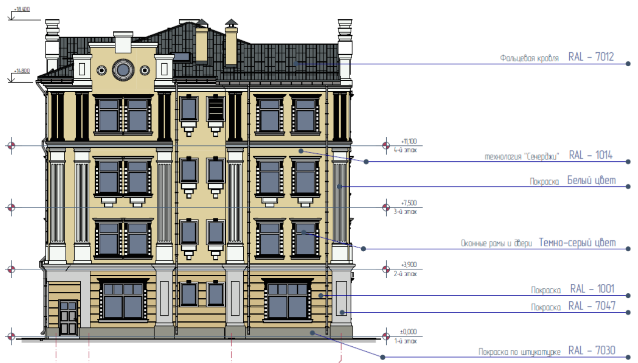
Рис. 11. Северо-западный фасад здания (фрагмент Паспорта отделки фасадов)
