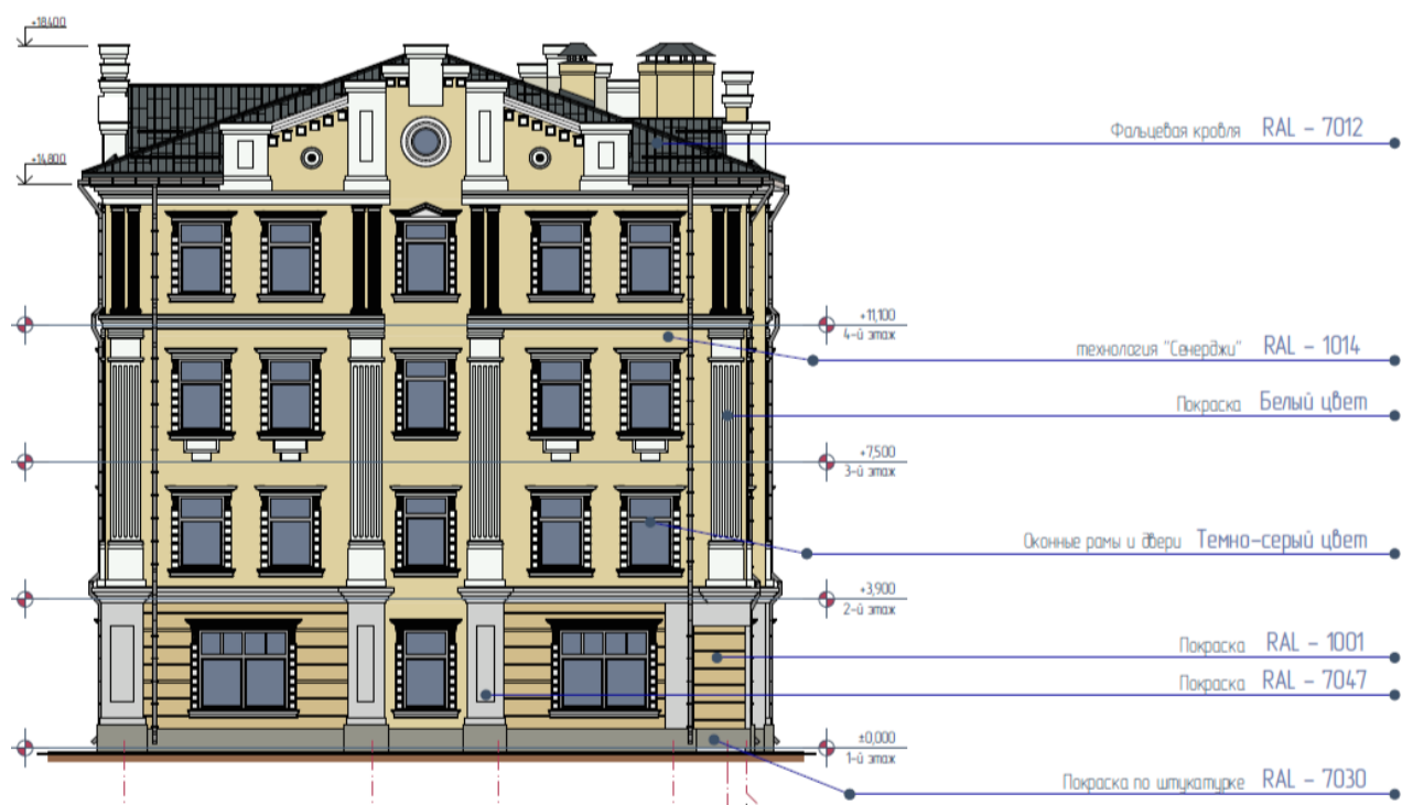
Рис. 10. Северо-восточный фасад здания (фрагмент Паспорта отделки фасадов)
